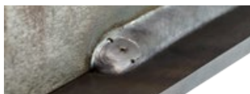
S plněním koncového kráteru – perfektní konec svaru
