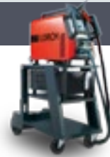
Mobil Car: Pojezdový vozík pro uložení zdroje V mobil a chladicího přístroje s vodním oběhem WUK 5
