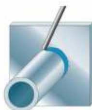
PF 5Fu Trubka: na pevno Osa: horizontální Poloha: zdola nahoru
