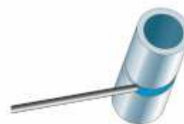
H-LO45 6G Trubka: na pevno Osa: skloněná Poloha: zdola nahoru
