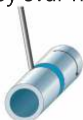
PA 1G Trubka: rotující Osa: horizontální Poloha: vodorovná shora
