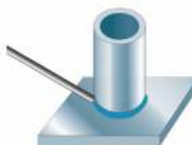
PB 2F Trubka: na pevno Osa: vertikální Poloha: vodorovná šikmo shora
